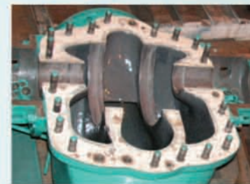
Восстановление полностью изношенной поверхности
