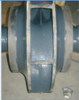
Трещины на лопасти были заделаны с использованием шпатлевки Loctite® Superior Metal. Loctite® Nordbak® 7227 Brushable Ceramic был применен в качестве второго слоя
