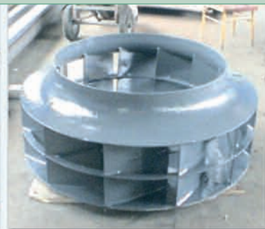
На первую лопасть нанесено покрытие
