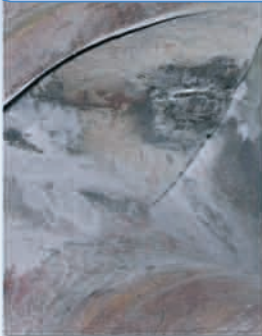
Рабочее колесо и корпус до ремонта. Сильный абразивный и кавитационный износ на колесе
