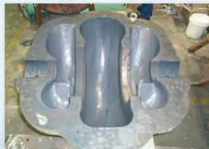
Loctite® Nordbak® 7227 керамический продукт (Серый) применяется для защиты подготовленной поверхности от коррозии. Восстановление сильно изношенных поверхностей с помощью износостойкой шпатлевки Loctite® 7222
