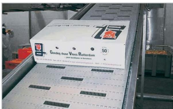
Надежный уклон поверхности 25° для скользких тяжелых пакетов на мясоперерабатывающем заводе.
