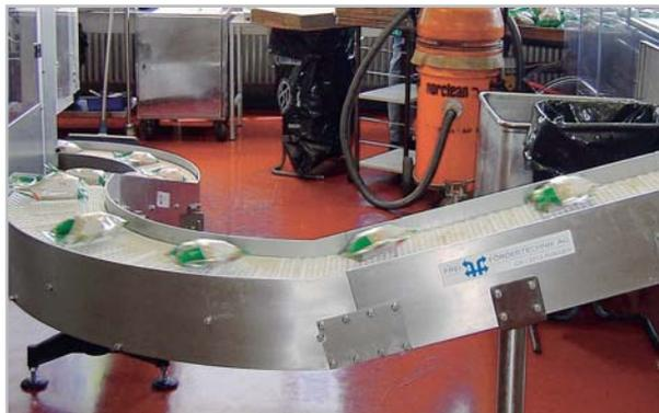
3-х мерная конструкция придает большую гибкость и сокращает количество точек пересопряжения зубьев и тянущих зубчатых барабанов.
