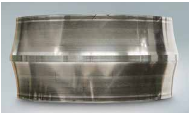
Фото 4.3 Деталь: Внутреннее кольцо подшипника качения со сферическими роликами Симптом: Размазывание по периферии поверхности следов вращения Причина: Недостаточная смазка
