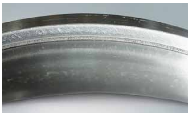
Фото 3.1 Деталь: Внутреннее кольцо подшипника качения со сферическими роликами Симптом: Задир на поверхности буртика внутреннего кольца Причина: Проскальзывание роликов вследствие резкого ускорения и торможения
