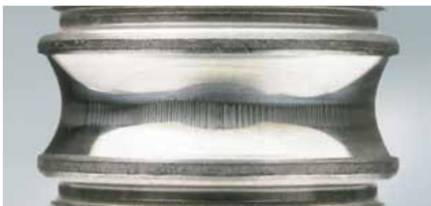
Фото 15.5 Деталь: Внутреннее кольцо шарикового подшипника Симптом: Рефление на поверхности следов вращения
