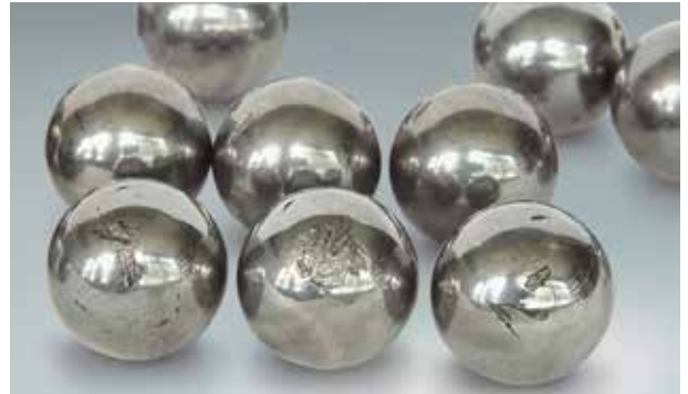
Фото 1.6 Деталь: Шарика с фото 1.4 Симптом: Усталостное отслаивание поверхности шарика Причина: Выбоины в результате ударной нагрузки в неподвижном состоянии
