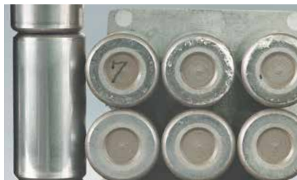
Фото 3.4 Деталь: Ролики двухрядного цилиндрического роликоподшипника Симптом: Задир на краю ролика Причина: Недостаточная смазка и чрезмерная осевая нагрузка
