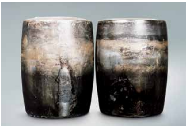
Фото 14.2 Деталь: Бочкообразные ролики с фото 14.1 Симптом: Изменение цвета и оплавление поверхности качения ролика, адгезия частиц изнашивания сепаратора Причина: Недостаточная смазка
