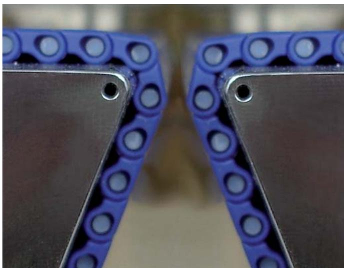
Micropitch - это новая уникальная модульная лента, позволяющая минимизировать длины переходных участков между конвейерами и обеспечивающая плавный переход высоких неустойчивых изделий и продукции, требующей аккуратной транспортировки.
