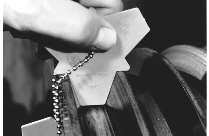
Использование калибров для шкивов облегчает определение износа.
