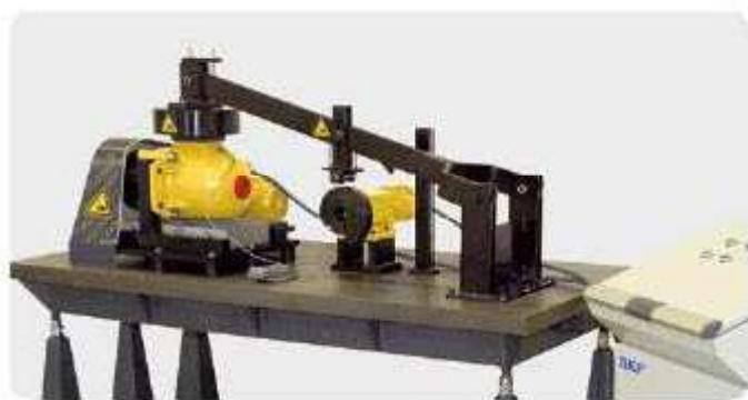
Машина V2F для испытания пластичной смазки
