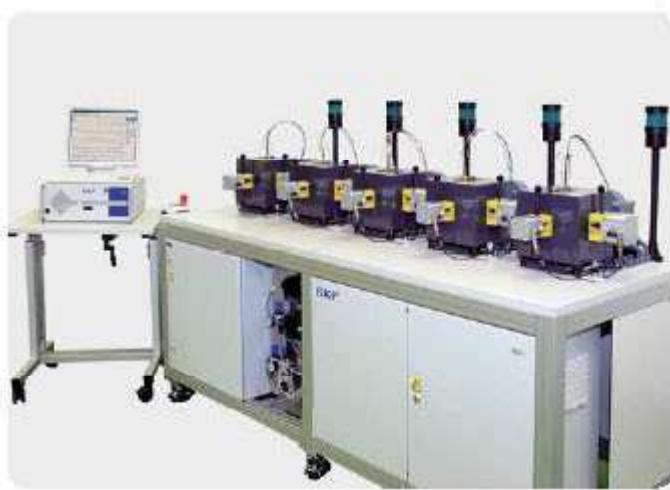
Машина ROF+ для испытания пластичной смазки
