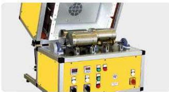
Машина для испытания стабильности при перекатывании
