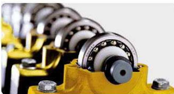
Машина Emcor для испытания пластичной смазки
