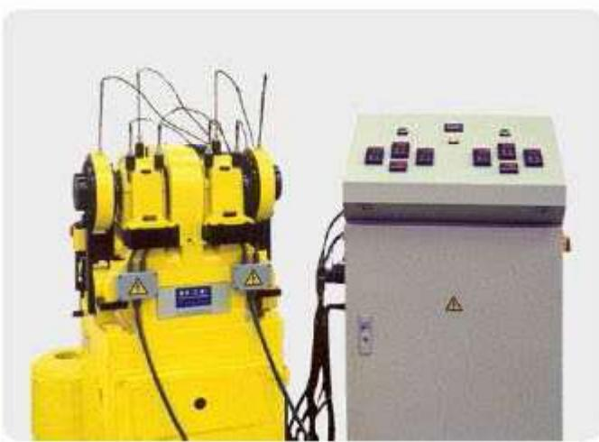
Машина R2F для испытания пластичной смазки
