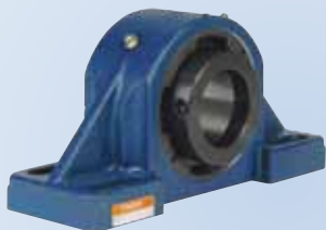
ЦЕЛЬНЫЕ КОРПУСНЫЕ узлы SO с СФЕРИЧЕСКИМ РОЛИКОВЫМ ПОДШИПНИКОМ диаметры валов от 40 до 180 мм; 1-7/16 до 7 дюймов
