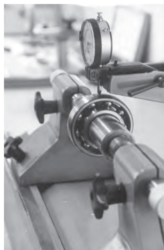
Рис. 10-11 Измерение - зазора - радиального удара
