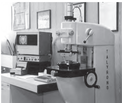
Рис. 4 Устройство для измерения отклонения от формы
