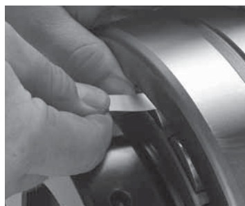
Рис. 18. Измерение РВЗ до монтажа.
