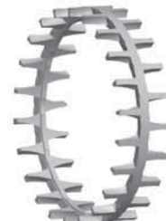
Рис. 8. Механически обработанный цельный латунный сепаратор пальцевого типа, направляемый кольцом.
